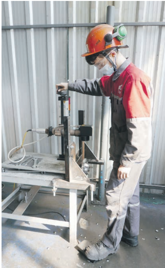
▲ Лазер ставит клеймо точно в заданном месте
